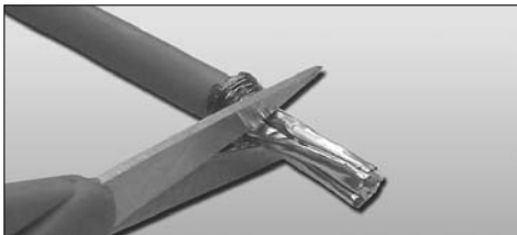
Paar-Schirmfolie einkerben und entfernen.
